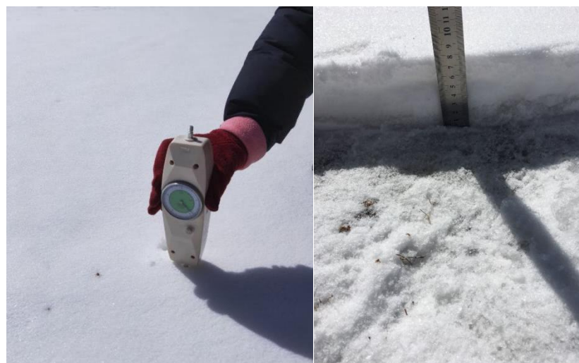
图1 利用硬度计测量积雪硬度（左）；积雪剖面照片（右）
